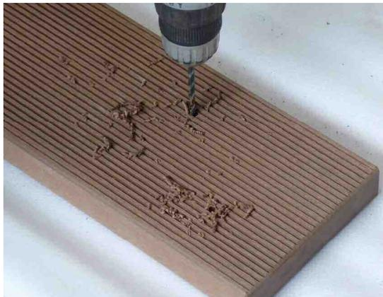
⑤④の印に合わせ、取付用穴(φ4.5x深さ 15mm)をあけます。(棚板が割れたり膨らんだりしますので、必ず規定の穴をあけてください。)
