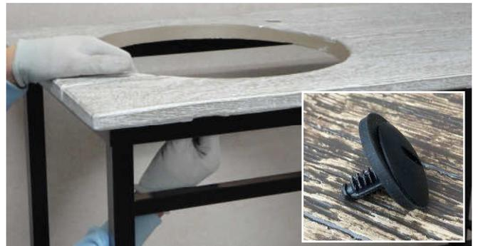
⑥ 天板をフレームに乗せます。フレームの下側からゴムワッシャーをかませた、ブラッシュクリップを天板の3か所の穴に差し込み固定します。ブラッシュクリップの入りが浅いときはゴムワッシャーをはずしてください。
