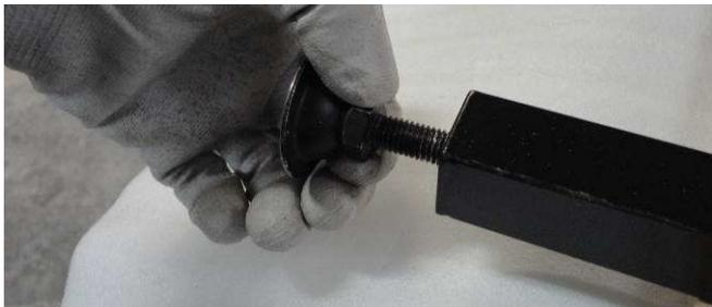
② 養生シートの上にフレームを寝かせて、脚の底面からアジャストボルト4本をねじ込みます。
