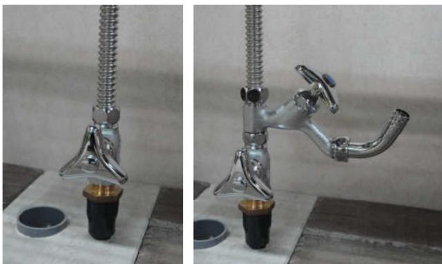
⑧床面から出しておいた給水管に化粧バルブを取り付けます。オプションのホース用分岐タップを取り付ける場合は、化粧バルブの上に取り付けます。(ゴムパッキンがない接続箇所はシールテープを右巻きに7~8回巻きます。化粧バルブのデザインが写真と異なる場合があります。ご了承ください。)
